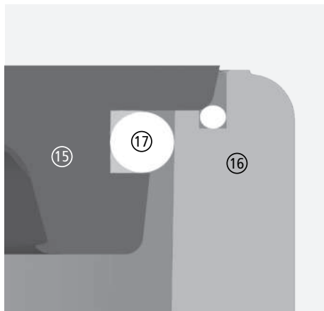
Obr. 3.14 Těsnění v horním litinovém kroužku, těsnící profil krytu
