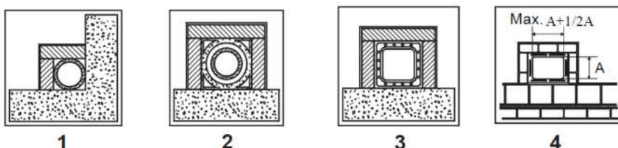
**1\*** Ocelový kouřovod s dvojitou izolovanou komorou s odolným materiálem do 400 °C. **Optimální účinnost 100%**.
