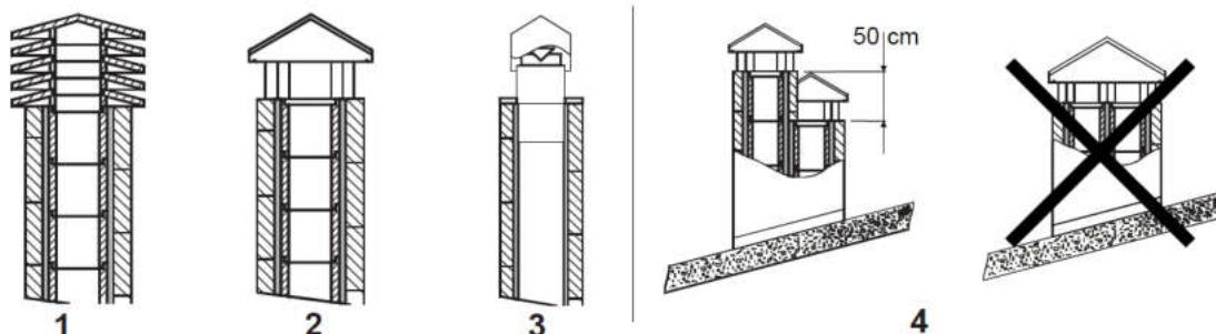
**1** Průmyslový komín s prefabrikáty umožňuje optimální odvod spalin.
