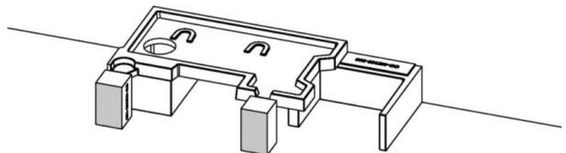
**Obr. 9: Uložte montážní kameny pro montáž vložky**
