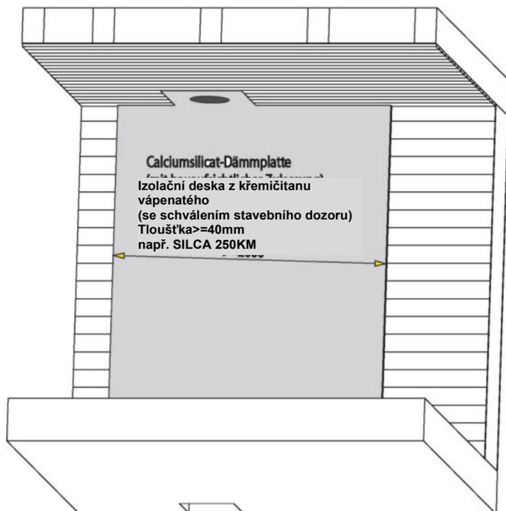
**Obr. 41: Připojení kouřovodu -
