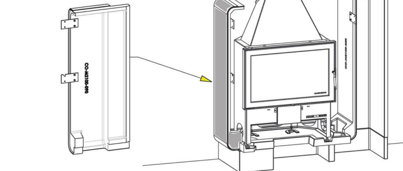
**Obr. 17: Montáž levé boční stěny**
