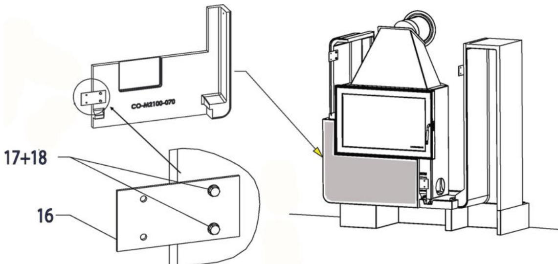
**Obr. 18: Montáž spojovacího plechu č. 2 na dolní rám**
