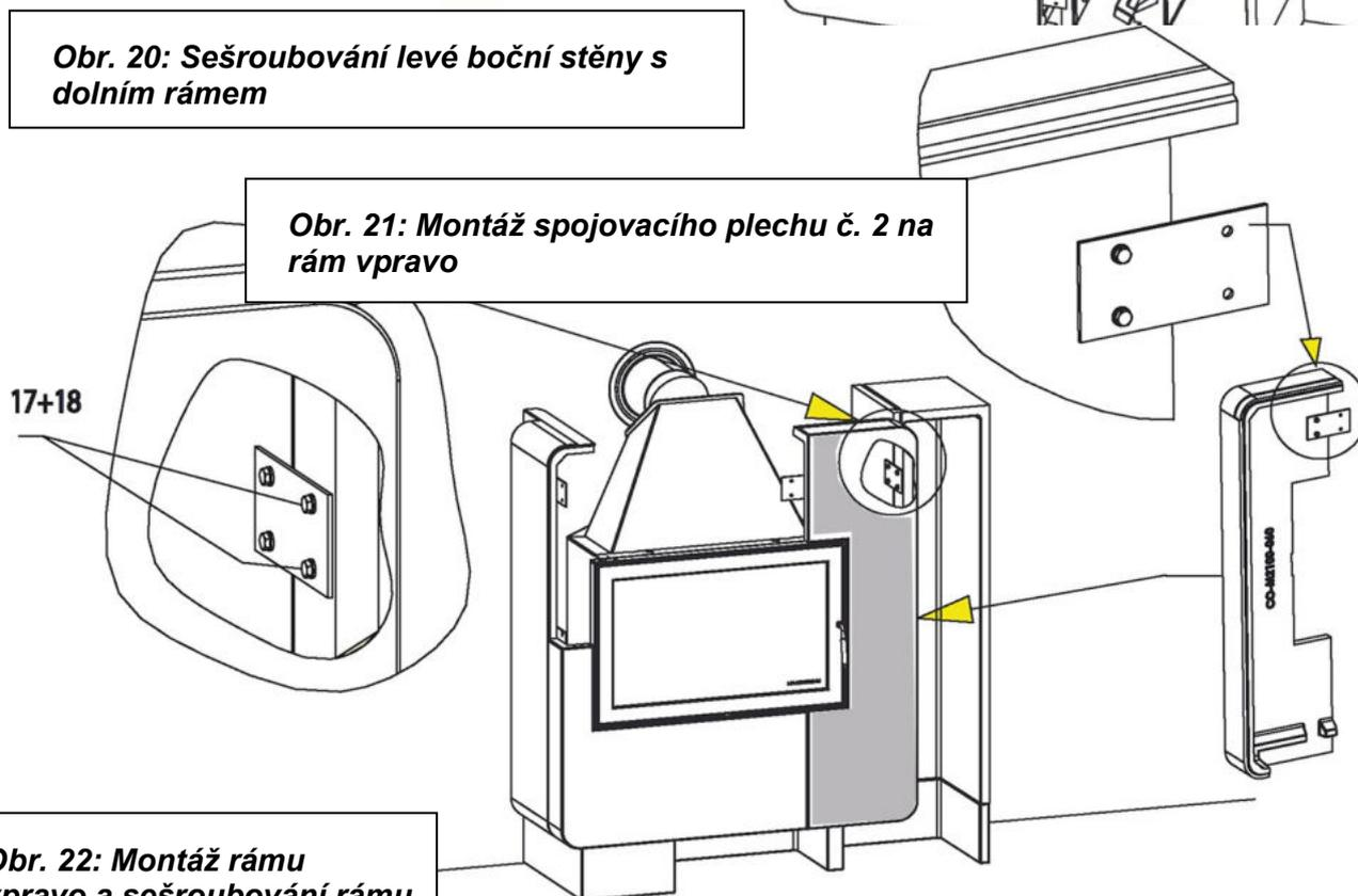
**Obr. 21: Montáž spojovacího plechu č. 2 na rám vpravo**
