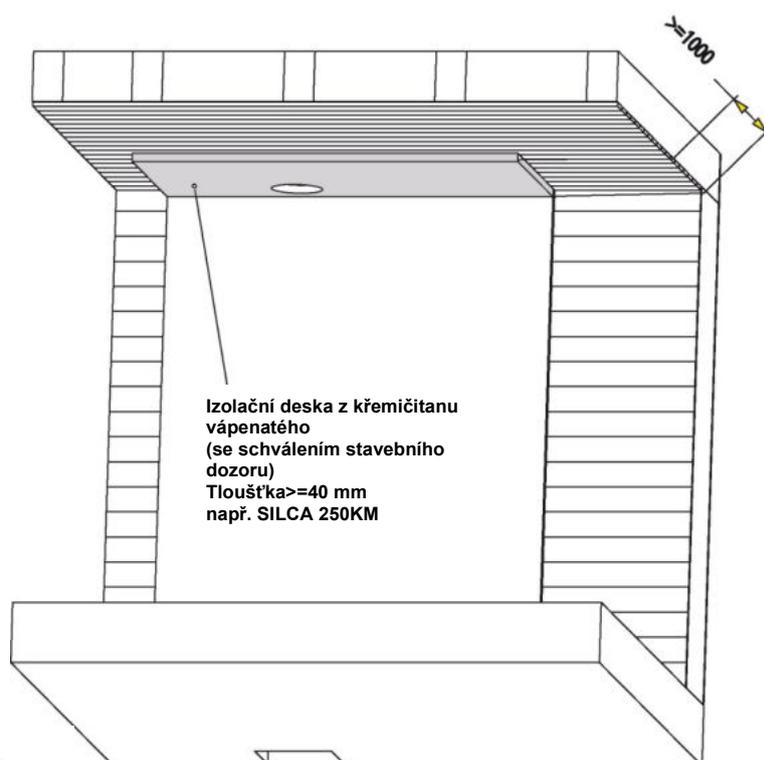
**Obr. 42: Připojení horního
