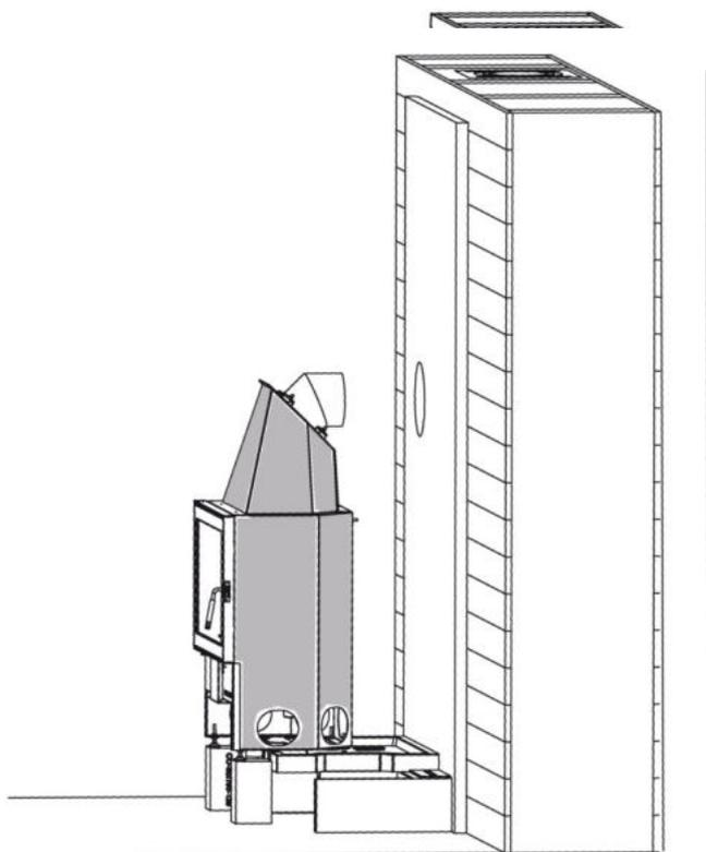
**Obr. 31: Umístění krbové vložky do určené polohy**
