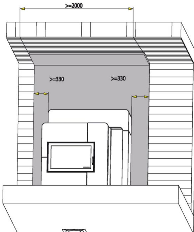
**Obr. 40: Protipožární směrnice -
