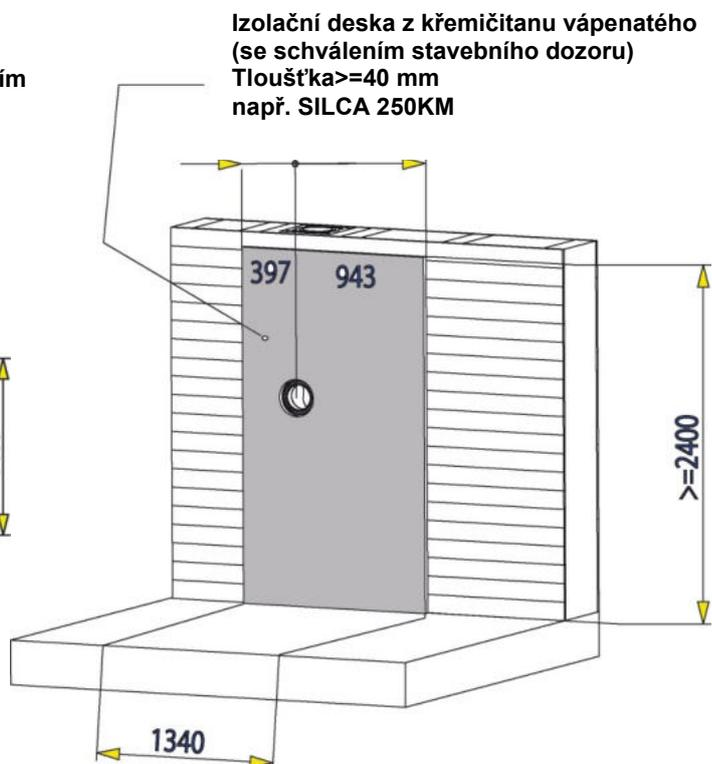
**Obr. 30: Montáž 40 mm izolačních desek z křemičitanu vápenatého**
