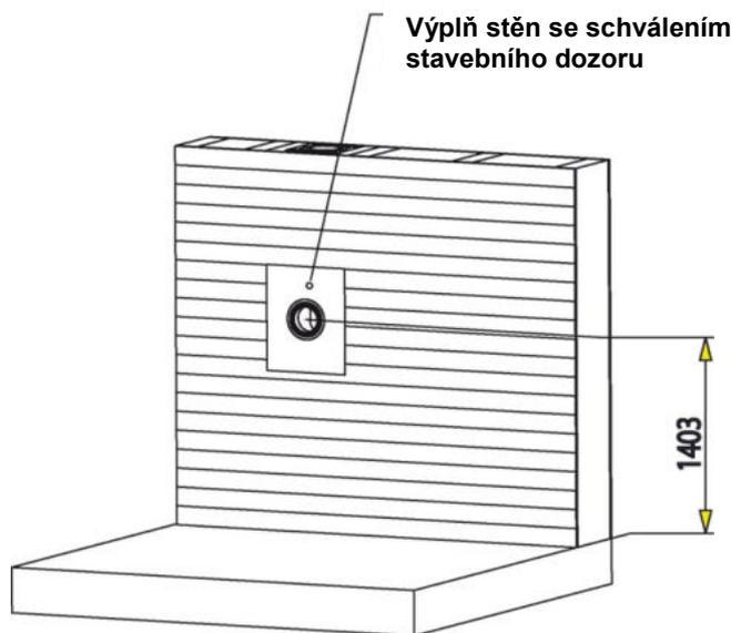
**Obr. 29: Montáž výplně stěn se schválením stavebního dozoru**
