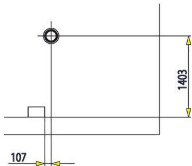
Obr. 2+3: Usad'te levý sokl do předepsané polohy
