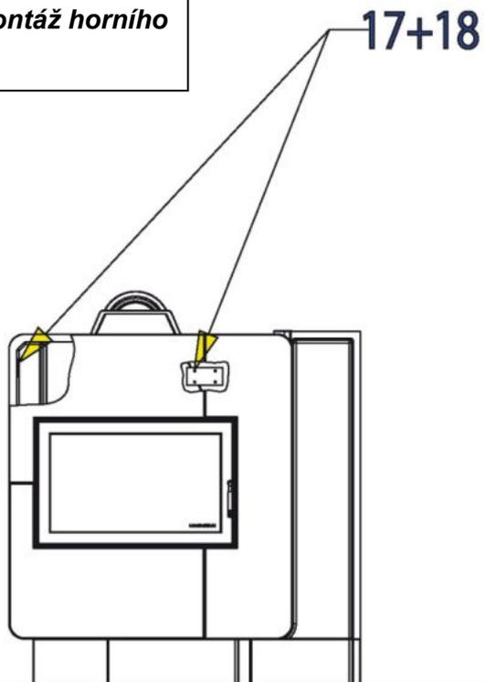
**Obr. 25: Montáž plechové clony (příhrádka na uložení dřeva)**
