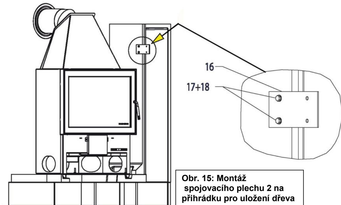
**Obr. 15: Montáž spojovacího plechu 2 na přihrádku pro uložení dřeva**
