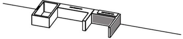
**Obr. 5+6: Usad'te pravý sokl do předepsané polohy**
