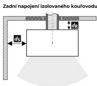
Prostup kouřovodu stěnou z hořlavé hmoty ČSN 06 1008
