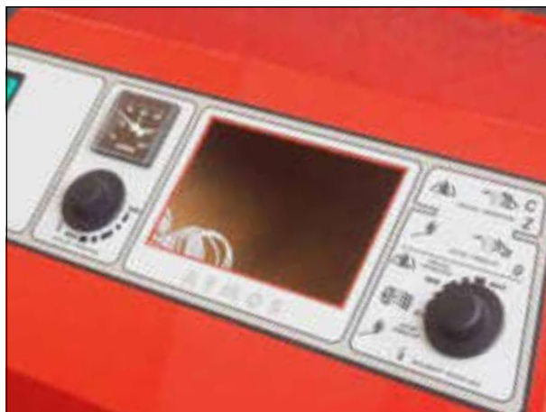
Vylomený otvor (92 x 138 mm)
