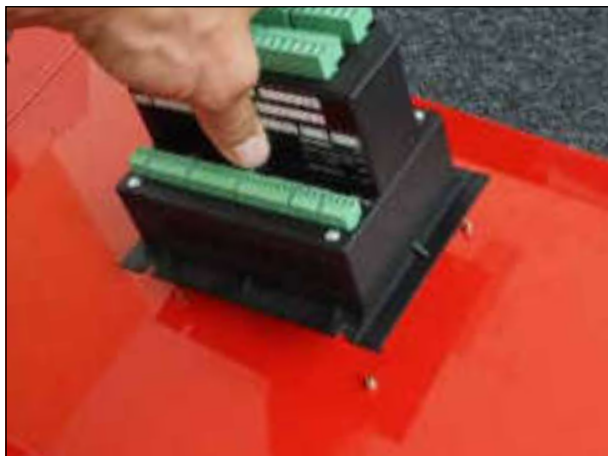
Nasazení regulátoru na čtyři šrouby M4
