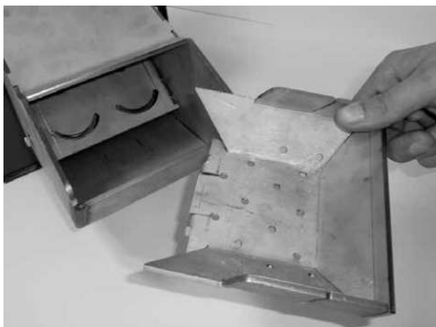
Obr. 1 - vyjímatelná spalovací komůrka - nutno pravidelně čistit
