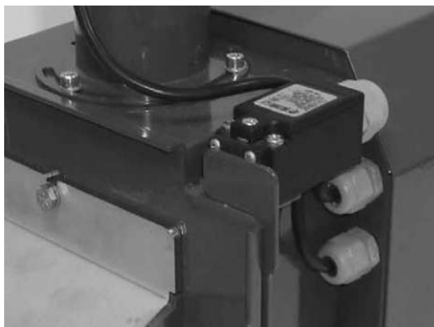
Obr. 8 - koncový spínač se speciálním dorazem
