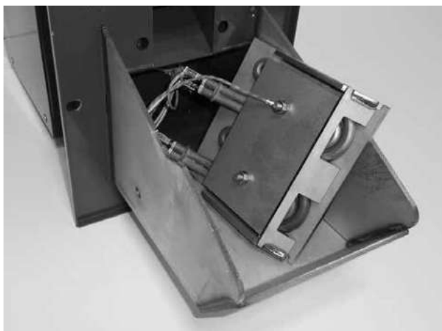
Obr. 3 - demontovaná deska se 2 zapalovacími spirálami
