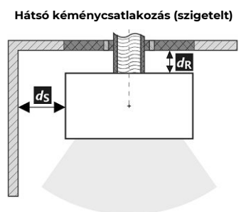
A füstcső áthaladása éghető anyagból készült falon
