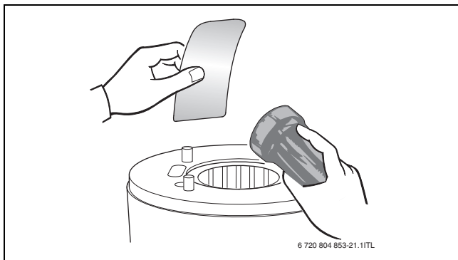
Obr. 53 Kontrola zbytků v tepelném výměníku
