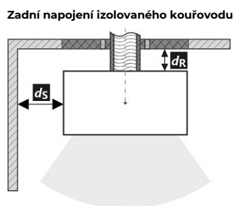
Prostup kouřovodu stěnou z hořlavé hmoty ČSN 06 1008
