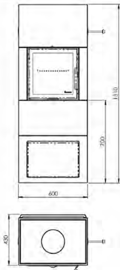
Salzburg S - záklop žárobeton/se zásobníkem na dřevo
