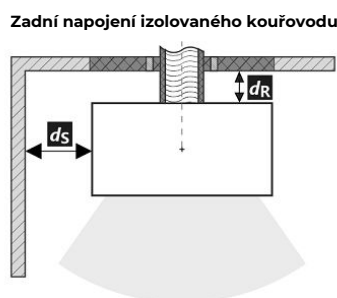
Prostup kouřovodu stěnou z hořlavé hmoty ČSN 06 1008
